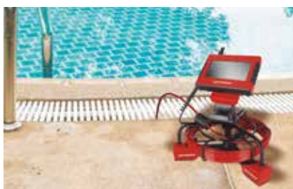
El módulo 20/16 HD permite inspecciones en tuberías pequeñas, como piscinas.
