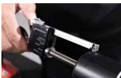
Ajuste sencillo al diámetro del tubo.
